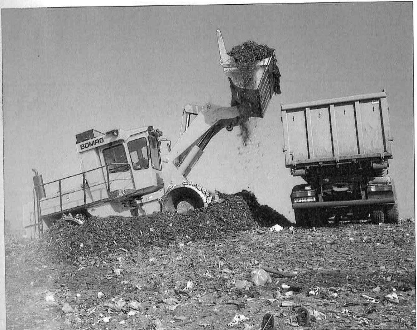
Die Schaufel macht den Müllverdichter zu einem universellen Arbeitsgerät.
