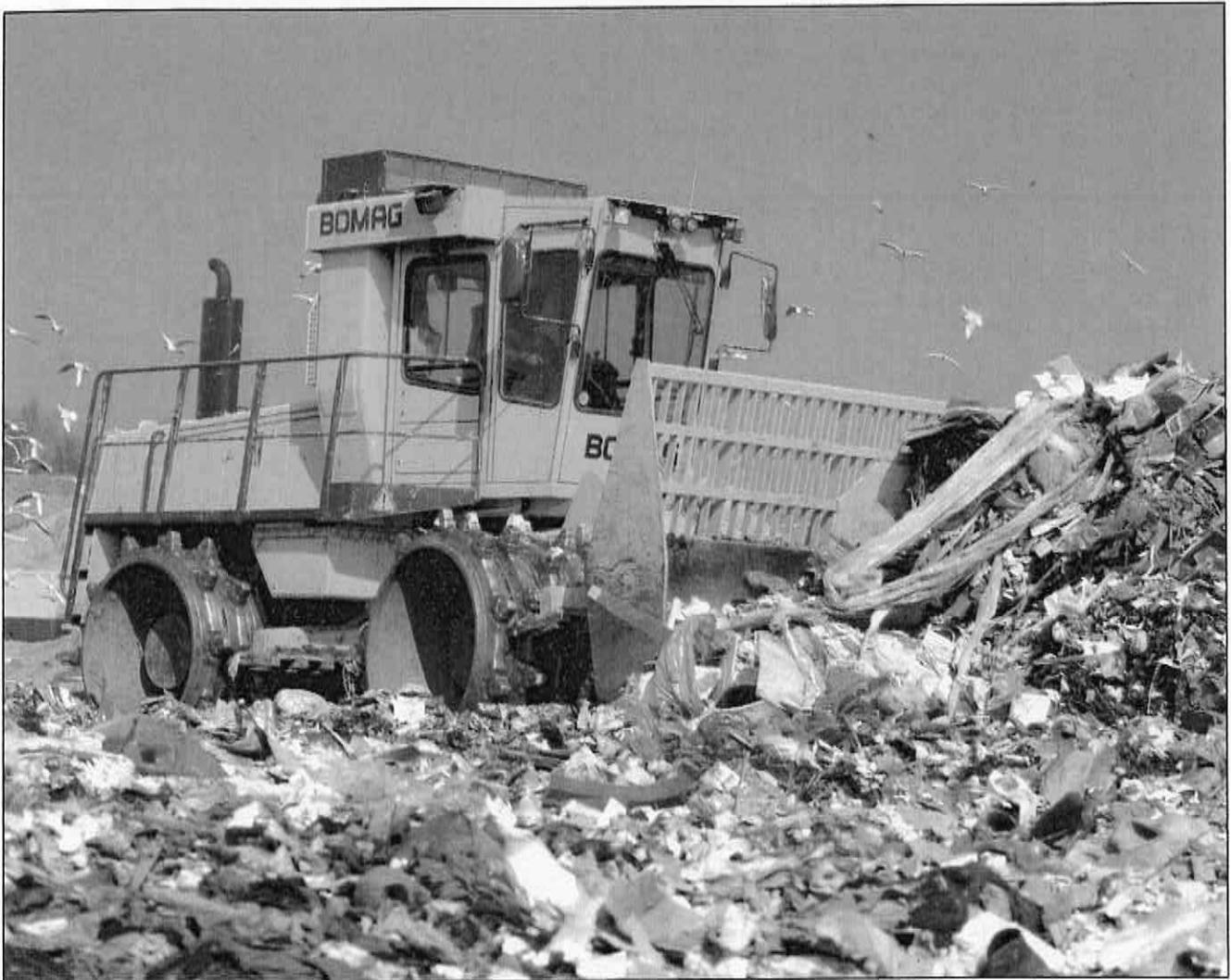
Mit dem breiten Schubschild wird der Müll effizient verteilt.
