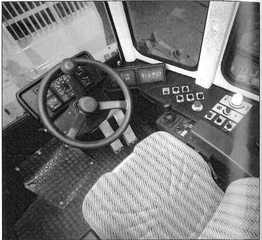
Ergonomische Anordnung sämtlicher Bedienelemente einschließlich verstellbarem Lenkrad
