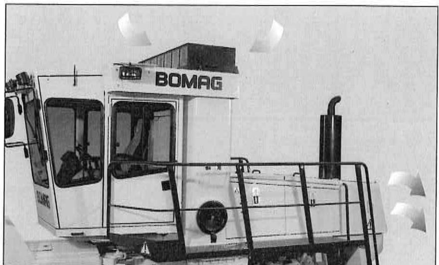
Nur bei BOMAG: Verlängerte Reinigungsintervalle durch Ansaugung der Motorkühlluft in 4 m Höhe.
