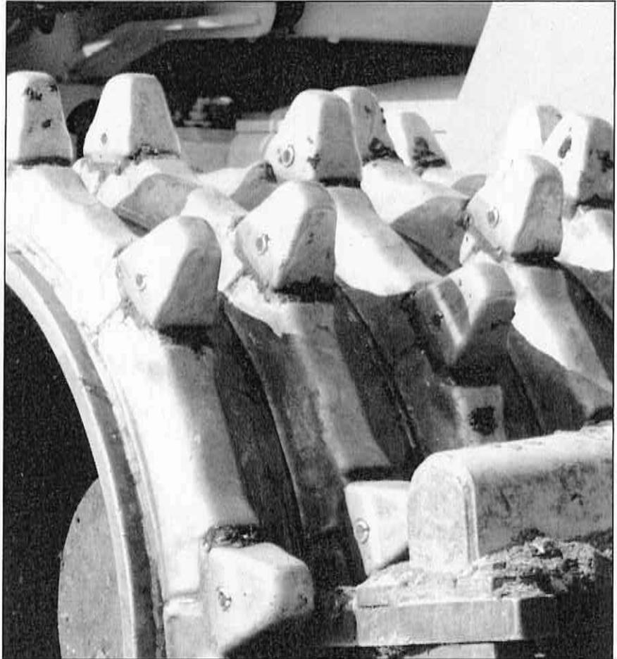
Nur bei BOMAG: Wechselkappen erhalten die maximale Verdichtungsleistung über ein ganzes Maschinenleben.
