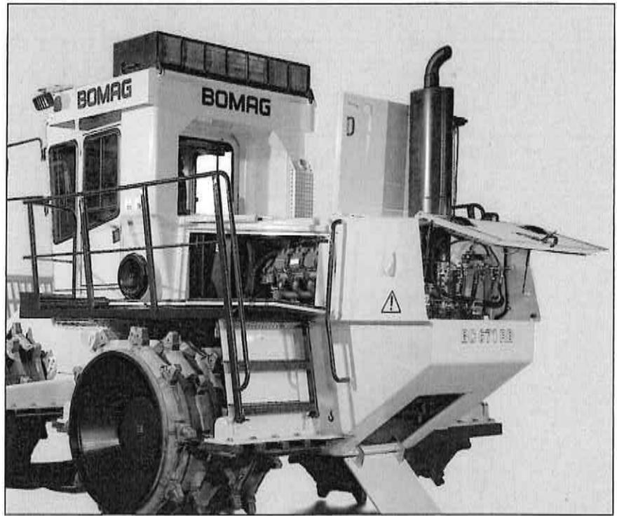
Der Zugang zum Motorraum ist durch die schwenkbaren Revisionsklappen mit wenigen Handgriffen frei.
