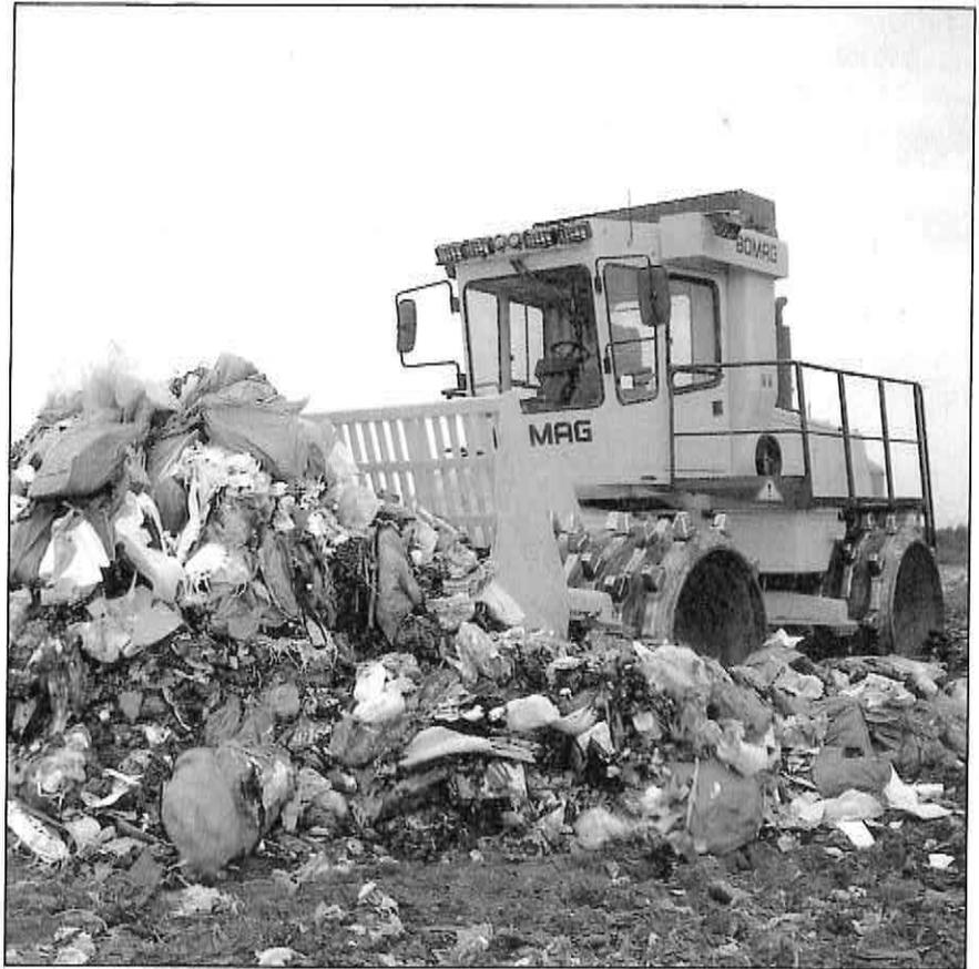
Hohe Schubkräfte ermöglichen den schnellen Einbau des Mülls
