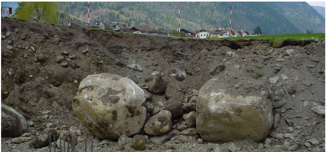
Foto 12: Detail aus dem Baugrund-Aufschluss der Feuerwehrrhalle: Murschutt-Ablagerungen mit über 1,5 m großen gerundeten Granitblöcken (Bilder zur Verfügung gestellt von der ausführenden Baufirma).
