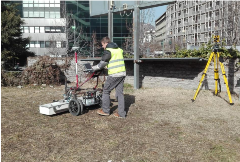
Immagine 8 - Rilievo georadar con Strumentazione IDS Stream X nelle aree di interesse
