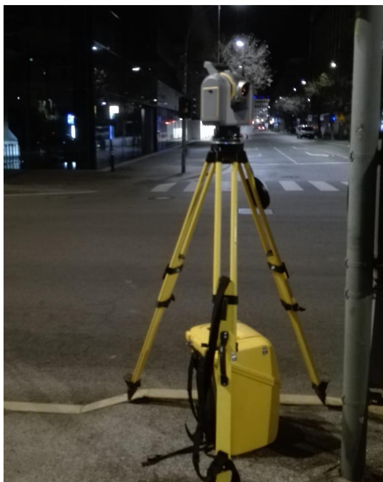
Foto – Esecuzione rilievo topografico tramite Stazione Totale Image Scanner
