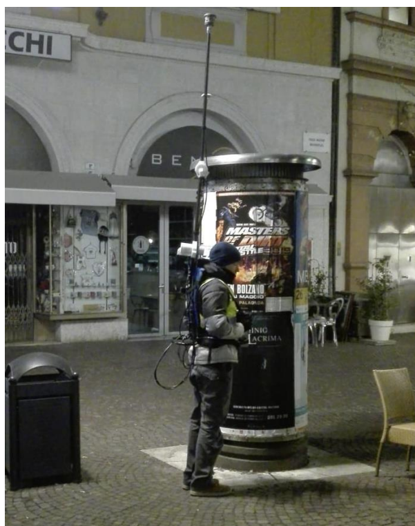
Foto – Rilievo gradiometrico con magnetometro GEM GSM-19 Overhauser
