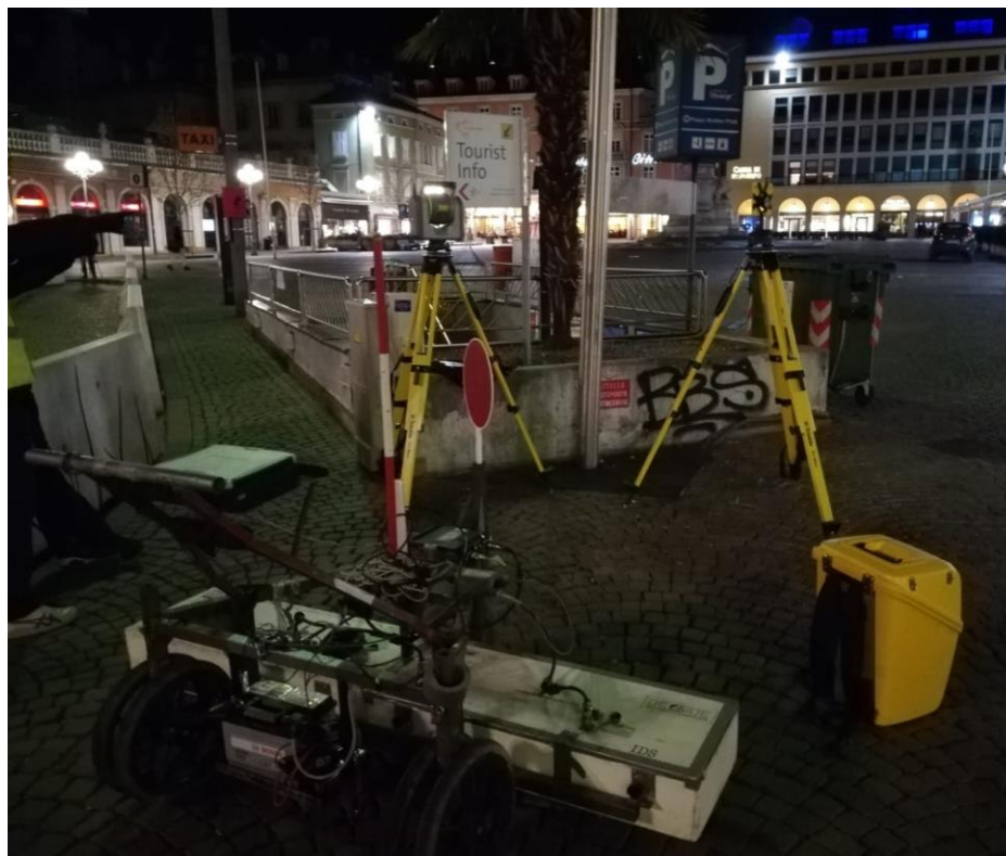
Immagine 15 - Esecuzione del rilievo topografico con Stazione Totale Image Scanner
