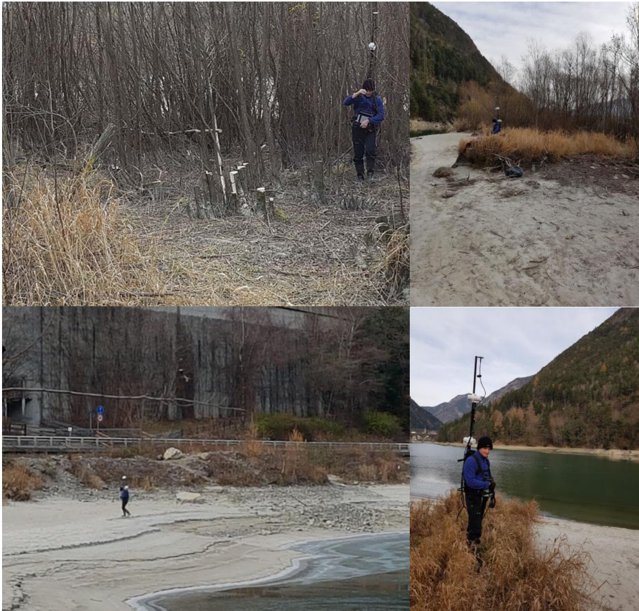
Rilievo gradiometrico con strumentazione GEM SYSTEM - GSM 19
