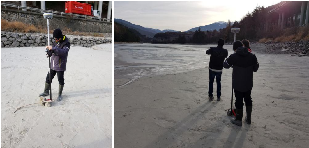
Tracciamento in campagna dei punti di interesse con strumentazione satellitare GNSS
