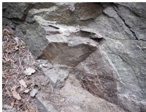
(f) Sede di distacco di un cuneo di roccia
