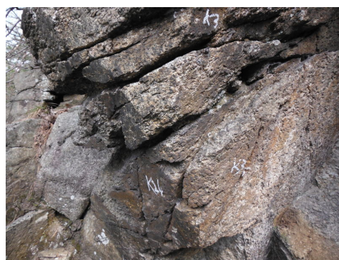
(f) Posizione reciproca delle discontinuità K3 e K4
