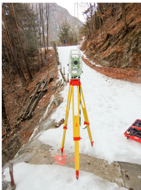
(a) Stazione topografica sull'attraversamento del torrente K6
