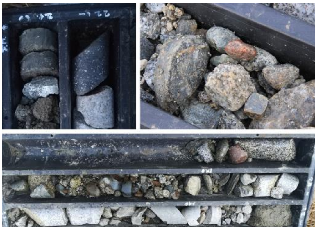
Foto 63: Dettagli del deposito di debris flow con intercalazioni di deposito alluvionale/torrentizio carotati nei sondaggi S2 e S3.
