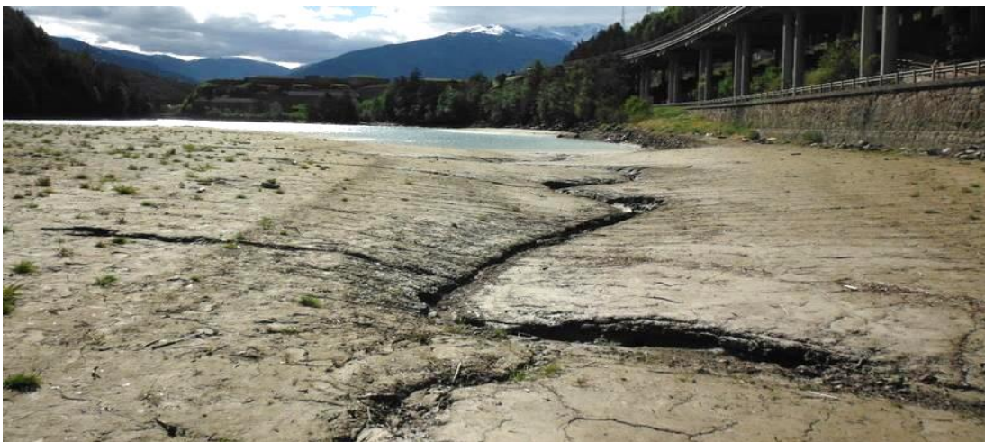
Foto 13: Dettaglio del solco erosivo prodotto dal flusso originato da una delle venute d'acqua individuate.
